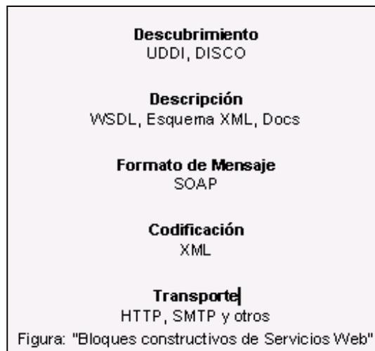
**Descubrimiento:** La aplicación cliente que necesita acceder a la funcionalidad que expone un Servicio Web necesita una forma de resolver la ubicación de servicio remoto. Se logra mediante un proceso llamado, normalmente descubrimiento (discovery). El descubrimiento se puede proporcionar mediante un directorio centralizado así como por otros métodos ad hoc. En DCOM, el servicio de descubrimiento lo proporciona el Administrador de control de servicios (SCM, Services Control Manager).
